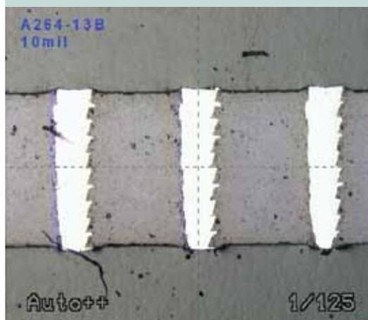
Рис. 2 Ag металлизация переходных отверстий в системе Ferro A6
